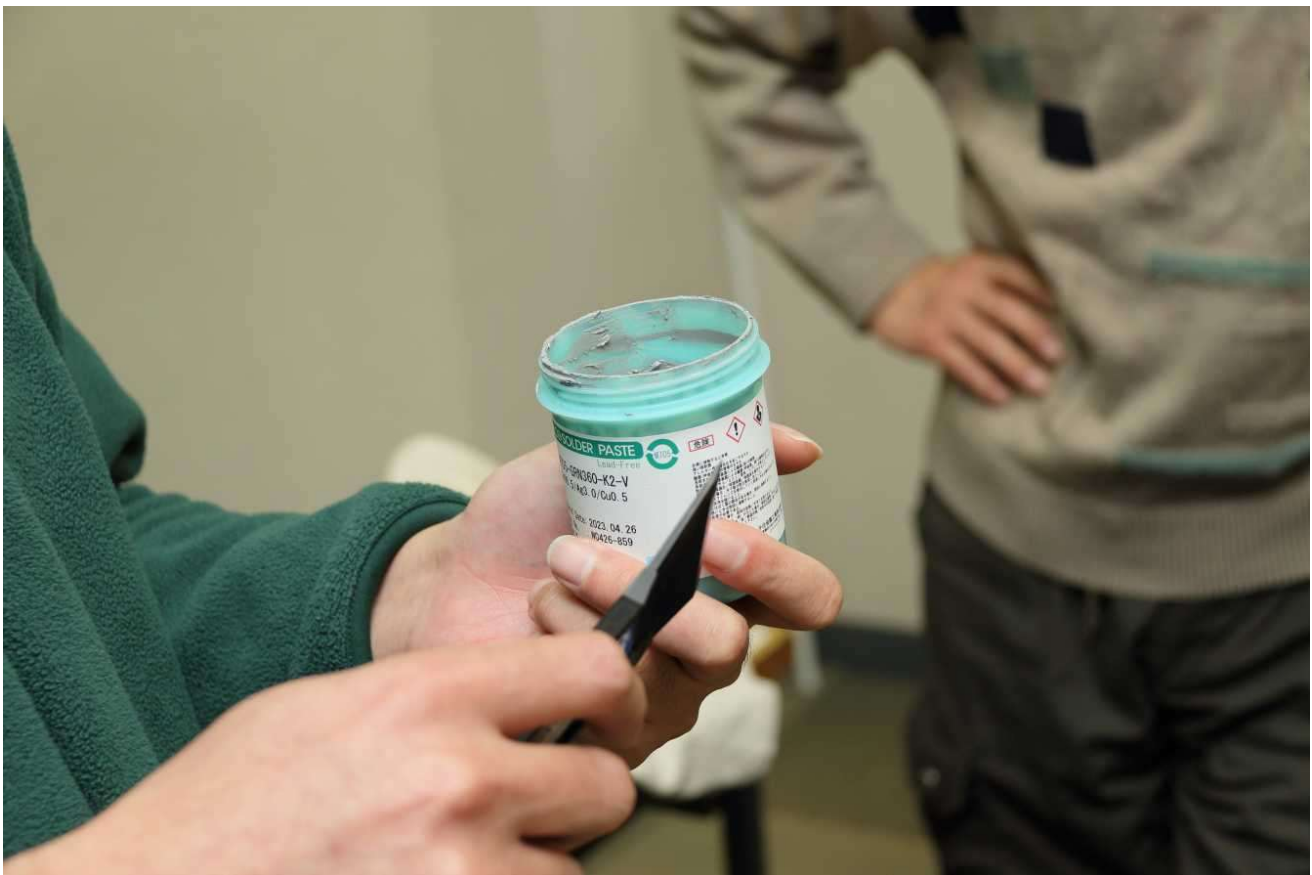
クリーム半田をヘラに付ける。 クリーム半田は保管温度や使用期限が決まっているが、業務使用ではないため 期限切れの物を使用した。「アマチュアでは十分に使用できる」
