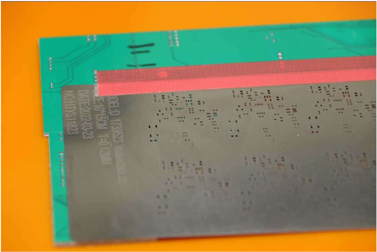
ハンダが載る部分だけ穴が空いている。 (マスクは6枚分であるが1枚分のみ使用)
