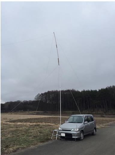
アンテナは、7K2HUG局が作製してくださったG5RVを10mの高さに上げて使用。6mの伸縮ポールに、約2mの棒を2本継ぎ足しています。飛び受けともに私には申し分なく、素晴らしいアンテナです。
