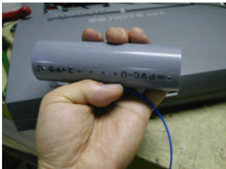
塩ビ管をカットし、ねじ穴を あけます。
