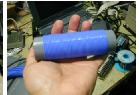
コイルの完成
